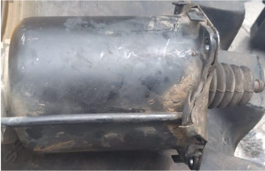
FOTOGRAFIAS: BOOSTER DEL EMBRAGUE CON DETERIORO
